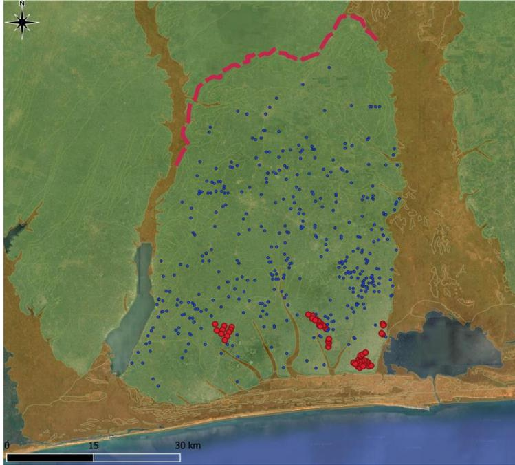
**Figure 15 :** Condition aux limites de type 1 : flux nul (line rouge) et flux imposé (les points rouges sont les champs captant et les points bleus sont les prélèvements privés).
