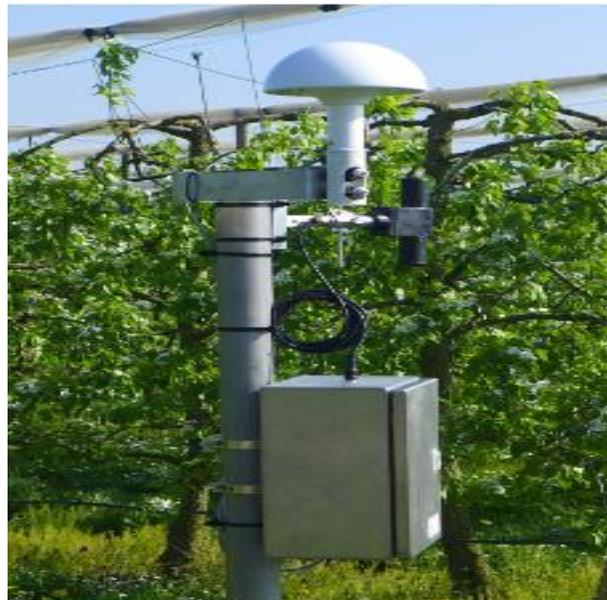
**FIGURE 1.4** – Photo d'un disdromètre acoustique RHD (source : <https://www.alliance-technologies.net/disdromètre-pluie-grêle-rhd/>)
