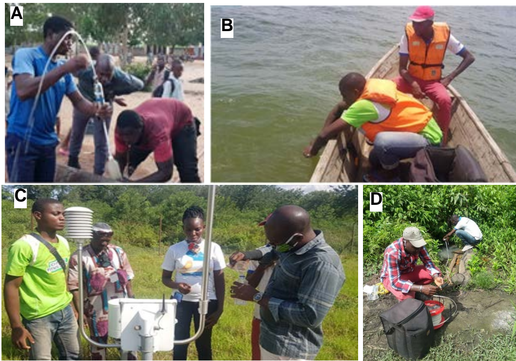
Figure 4 : Prélèvements d'eau pour analyses hydro-chimiques. 4A: eau souterraine; 4B: lac Nokoué; 4C eau de pluie; 4D eau de source
