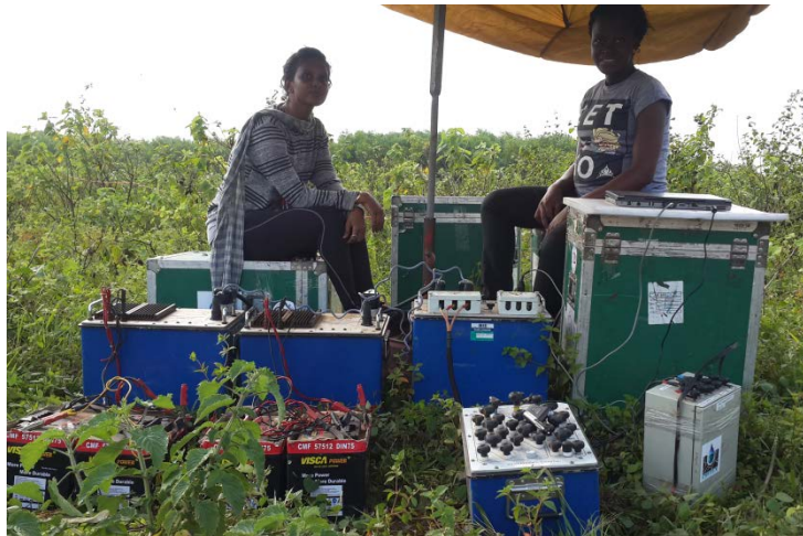
Photo 1 : Réalisation d'un sondage géophysique RMP, photo F. Lawson
