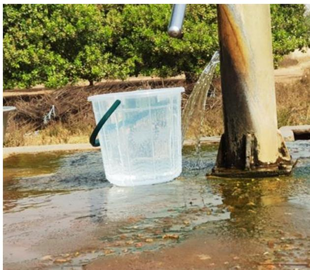
**Figure 15 : Mesure du débit à BOUANRI (BEMBEREKE)**
